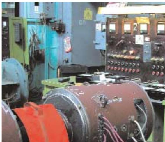
**Испытание под нагрузкой каждой электрической машины**
