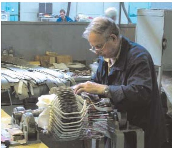
**Изготовление многослойных катушек обмотки якоря**
